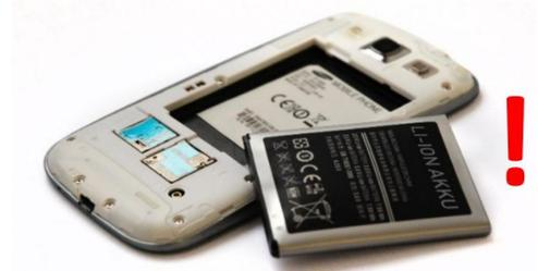
Besondere Vorsicht gilt bei beschädigten, aufgeblähten Akkus – diese können sich durch einen Kurzschluss der Pole, durch Korrosion oder auch durch Wärmeeinwirkung (z.B. im Sommer im heißen Auto) selbst entzünden.
